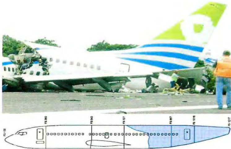
Vista lateral izquierda de la sección trasera del Fuselaje
