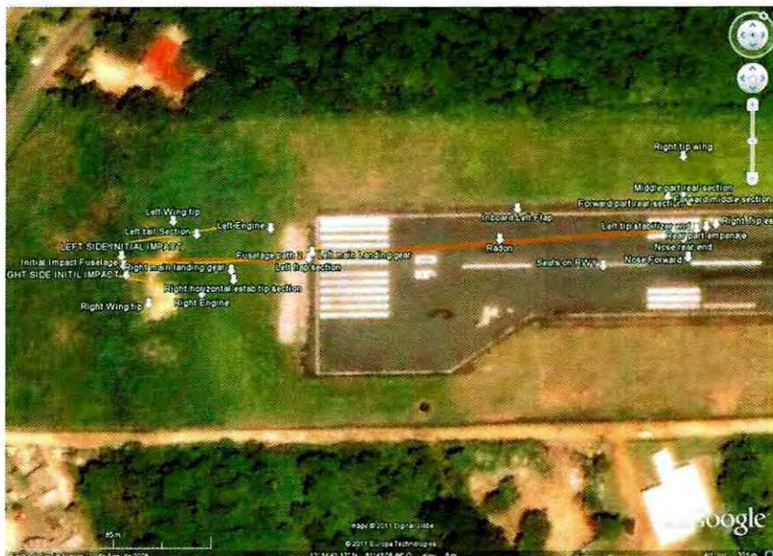
Vista superior de la distribución general GPS de los restos de la aeronave (Derecha a Izquierda)
